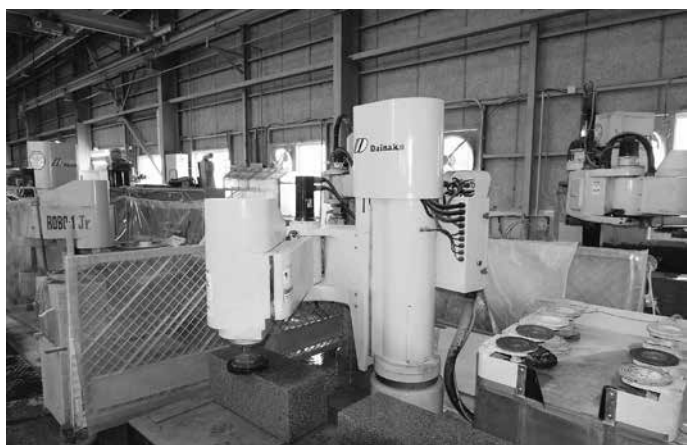
自動研磨ロボットが導入された本社工場
